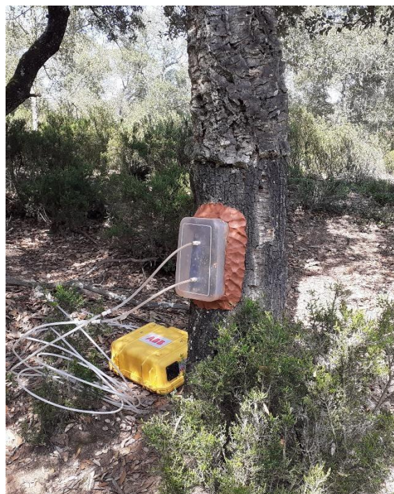
Figura 10: Mesura de la respiració dels troncs A) en la zona inferior d'alzines sureres pelades, i B) control. Fotografies: J. Barba
