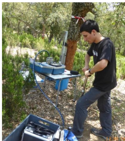
Figura 7: Mesura del potencial hídric. A) Cambra de pressió on es pot veure el manòmetre, la cambra amb la branqueta a l'interior i la connexió amb l'entrada d'aire. B) Preparació de la branqueta d'alzina surera amb 3 o 5 fulles que s'introduirà a la cambra de pressió. C) Observació de la superfície lliure de la tija per a poder determinar el moment en què el contingut del xilema surt sota pressió a l'exterior, valor que en signe negatiu coincideix amb el potencial hídric de la planta. D) Introducció d'aire a la cambra amb una manxa mecànica per a fer augmentar la pressió sobre el teixit. Fotografies: A, B i D, D. Verdaguer; C, M. Fontrodona
