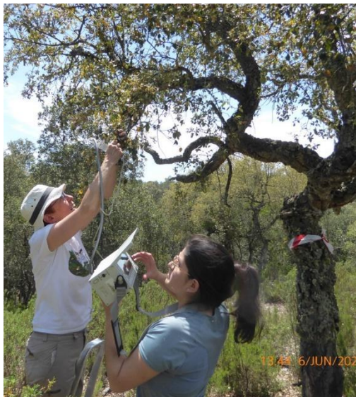
Figura 9: Mesura de la fluorescència de les clorofil·les en les fulles d'alzina surera amb un fluorímetre modulad portàtil (PAM-2100 Heinz Walz GmbH, Effeltrich, Alemanya) A) en condicions de llum i B) posant les pinces que han de permetre mesurar la fluorescència de les fulles després d'haver estat un mínim de 30 minuts a la foscor. Fotografies: D. Verdaguer
