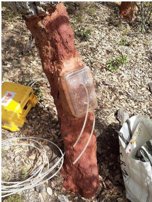
Figura 10: Mesura de la respiració dels troncs A) en la zona inferior d'alzines sureres pelades, i B) control. Fotografies: J. Barba
