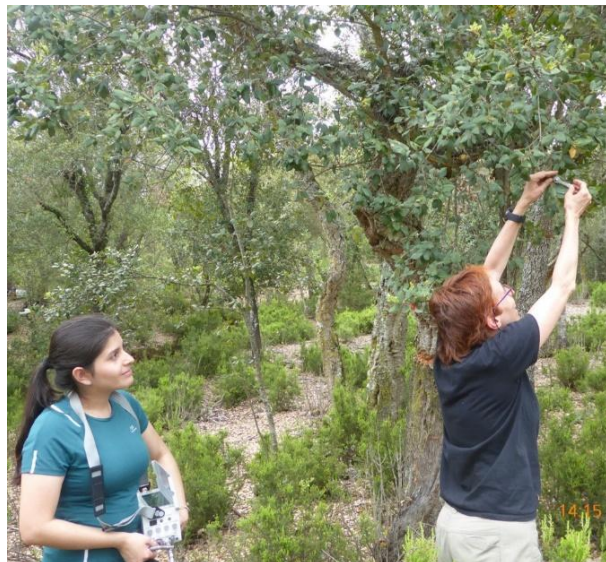
Figura 9: Mesura de la fluorescència de les clorofil·les en les fulles d'alzina surera amb un fluorímetre modulad portàtil (PAM-2100 Heinz Walz GmbH, Effeltrich, Alemanya) A) en condicions de llum i B) posant les pinces que han de permetre mesurar la fluorescència de les fulles després d'haver estat un mínim de 30 minuts a la foscor. Fotografies: D. Verdaguer
