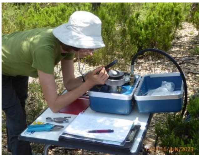
Figura 7: Mesura del potencial hídric. A) Cambra de pressió on es pot veure el manòmetre, la cambra amb la branqueta a l'interior i la connexió amb l'entrada d'aire. B) Preparació de la branqueta d'alzina surera amb 3 o 5 fulles que s'introduirà a la cambra de pressió. C) Observació de la superfície lliure de la tija per a poder determinar el moment en què el contingut del xilema surt sota pressió a l'exterior, valor que en signe negatiu coincideix amb el potencial hídric de la planta. D) Introducció d'aire a la cambra amb una manxa mecànica per a fer augmentar la pressió sobre el teixit. Fotografies: A, B i D, D. Verdaguer; C, M. Fontrodona
