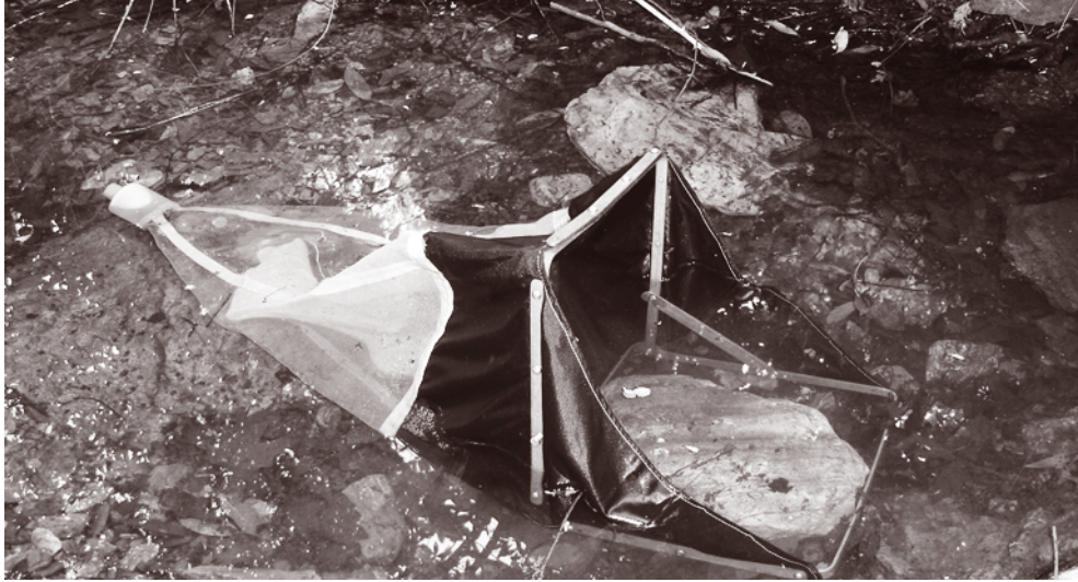
Fotografia 2. Xarxa surber utilitzada en el mostreig de macroinvertebrats en ambients lòtics.
