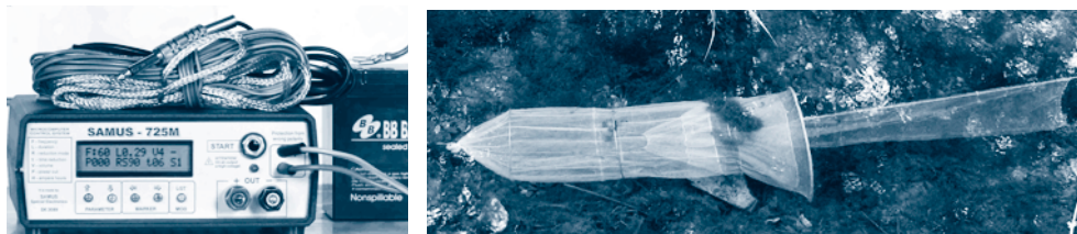
Figura 4. Equipament de mostreig utilitzat: a l'esquerra, equip portàtil de pesca elèctrica (SAMUS); a la dreta, barbol de malla petita
